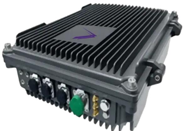
O FC505 é uma Unidade de Rádio O-RAN avançada, com configuração 4T4R e 5W por porta, projetada para uso externo (IP65). Compatível com 5G NR da 3GPP, segue o padrão O-RAN 7-2x split, suporta interface Fronthaul CUSM, bandas TDD/n48/n78, antenas externas 4T4R e uma portadora (1CC) com até 100 MHz de largura de banda.
